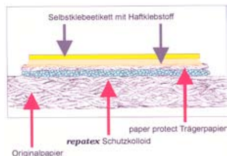
Wirkungsprinzip des repatex paper protect-Schutzetiketts.
